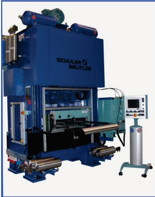
*Der Einpleuel-Stanzautomat AZ 630 wurde für die Herstellung von Aluminiumverpackungen entwickelt. Mit dem Einsatz der Zwischenlagen aus dem Hause Georg Martin wird eine enorme Zeitersparnis in der Endmontage erzielt.*
