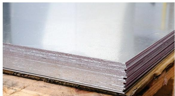
*Le lastre di spessori metallici ad alta precisione e a bassa sbavatura in acciaio, acciaio inossidabile, ottone o alluminio vengono prodotte da MARTIN sul suo nuovo impianto di rifilatura.*
