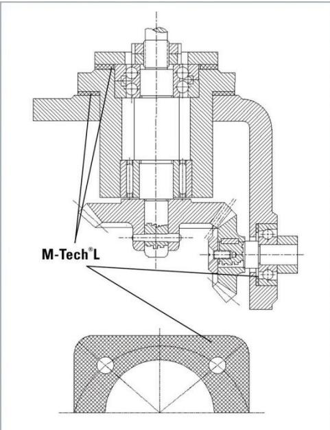
*Il gioco assiale degli alberi di trasmissione può essere compensato, risparmiando sia sui tempi sia sui costi, utilizzando laminati metallici di tipo M-Tech®.*
